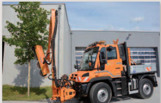
Das Freischneidegerät, das am Unimog zum Einsatz kommt, ist eine große Arbeitserleichterung für das Team des Städtischen Bauhofs.
